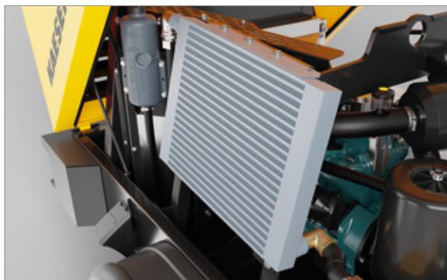
Refroidisseur final d'air comprimé
