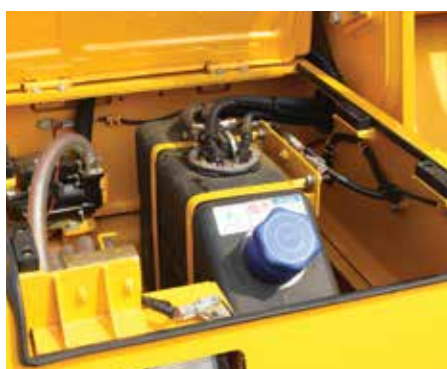
POMPE DE REMPLISSAGE DU CARBURANT
